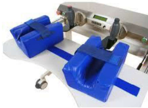
Figura 3. Robotul de reabilitare a membrilor superioare Bi-Manu-Track
