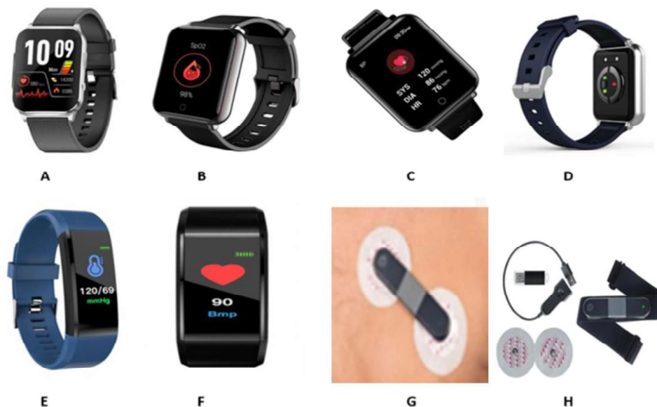
Figura 20. Dispozitive mecanice inteligente folosite pentru monitorizarea la distanță diferiți parametri cardiovasculari. A-D - Ceas inteligent – măsurare electrocardiogramă, saturația oxigenului, tensiunea arterială sistolică și diastolică, cele 2 LED-uri care emit unde de lumină. E,F – brățară fitness medicală – măsurare tensiune arterială, frecvență cardiacă. G, H – plasturi și senzori de monitorizare a electrocardiografei
